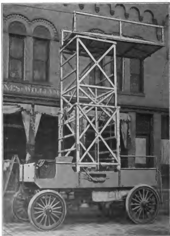
Fig. 226. Automobil-Montagewagen von O. G. Roberts & Co., Columbus O. (Plattform gehoben.)
